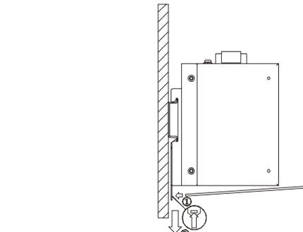
第三步: 导轨卡扣与DIN35mm导轨解锁后, 按装配的反顺序, 先把产品下方往后轻抬脱离导轨后再往上抬起即完成拆卸。
