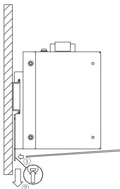
第三步：导轨卡扣与DIN35mm导轨解锁后，按装配的反顺序，先把产品下方往后轻抬脱离导轨后再往上抬起即完成拆卸。
